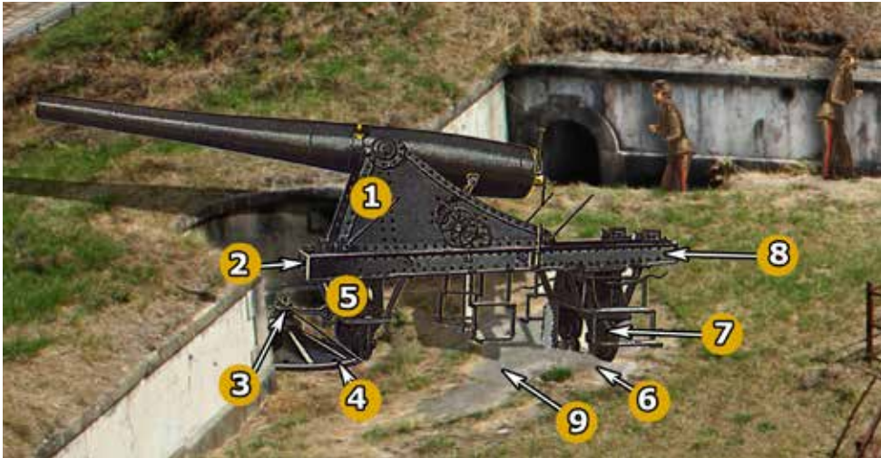
Montaje fotográfico de un Cañón HE «Ordóñez» de 15 cm sobre marco alto en el frente norte de la Obra de la Derecha. 1 Cureña. 2: Teleras. 3: Perno pinzote. 4: Basacarril. 5: Ruedas de testera. 6: carrilera de contera. 7: Ruedas de contera. 8: Brancales. 9: Explanada.
