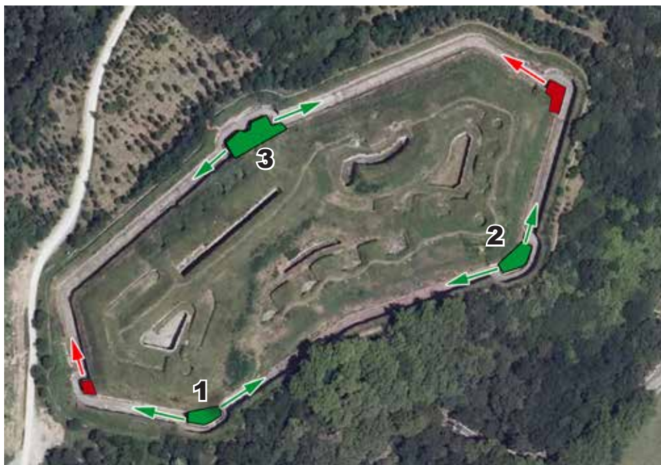
En color verde están señaladas las caponeras y en color rojo las semicaponeras. Las flechas indican los tramos de foso que respectivamente defienden. 1 caponera SW. 2 caponera SE. 3 caponera de gola.
