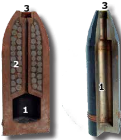
Izda. granada de metralla ( shrapnel ) 1: explosivo. 2. balines. 3 rosca para la espoleta. Dcha: granada rompedora (o «granada torpedo»), de principios del siglo XX.
