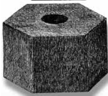
Prismas de pólvora de siete y e un canales.
