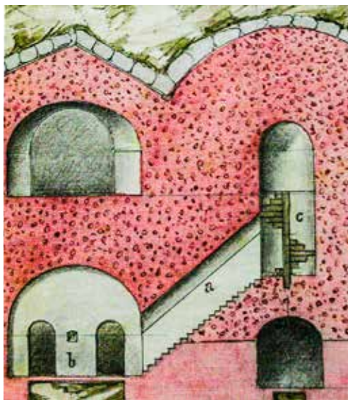
b: vestíbulo del depósito de distribución de munición de la Obra de la Izquierda . a: escalera. c: escalera de caracol que conduce a la estancia anexa al observatorio.
