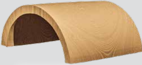
Bóveda de cañón
